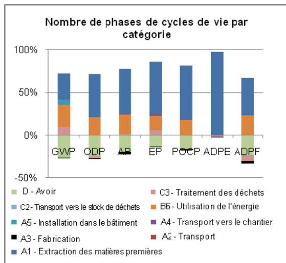
Dans la phase de fabrication, les composants en aluminium anodisé et recouverts de résine de polyester ainsi que les matériaux affichant la masse la plus élevée – les plaques en MDF, sont considérés comme les modules potentiellement les plus risqués pour l'environnement.
