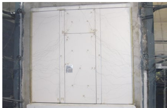
Lors des tests en laboratoires pour déterminer la classe de résistance au feu, une paroi de la Variflex EI 30 avec porte d'accès intégrée a été soumise à un feu direct pendant une demi-heure.
