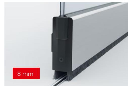
Pratiquement invisible : Le rail encastré dans le sol a une largeur de 8 mm seulement et permet donc de marcher sans trébucher. Les profils PTFE intégrés permettent un fonctionnement silencieux et sans heurts.
